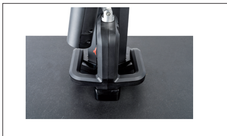
7. ábra Fogantyúk a mérőkészülék mozgásához
