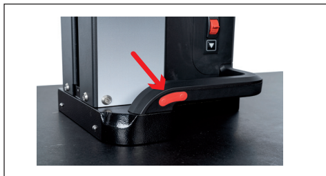
6. ábra Nyomógomb a légcsapágy aktiválásához
